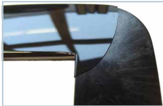
Bild 3. Bereits bei der Entnahme ist die Lackschicht so weit ausgehärtet, dass die Oberfläche nicht zerkratzt
