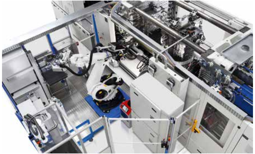
Bild 3. Bereits bei der Entnahme ist die Lackschicht so weit ausgehärtet, dass die Oberfläche nicht zerkratzt
