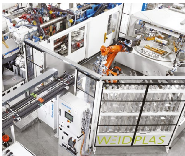
Die vollautomatisierte Spritzgießzelle produziert im einstufigen Verfahren baufertige A-Säulenverkleidungen.
